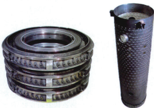
图1 真空钎焊焊接的涡轮导向器、火焰筒
